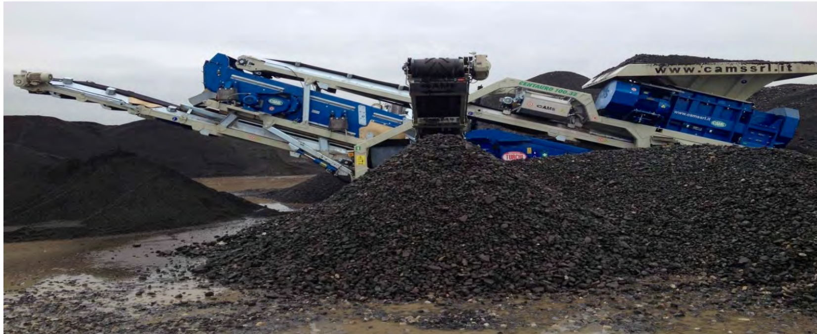
Impianto per la frantumazione e la vagliatura di materiale di recupero edilizio o di conglomerato bituminoso stradale a Milano, Italia. Crushing plant and screening of inert solid waste from the construction industry or RAP (Reclaimed Asphalt Pavements) in Milan, Italy.
