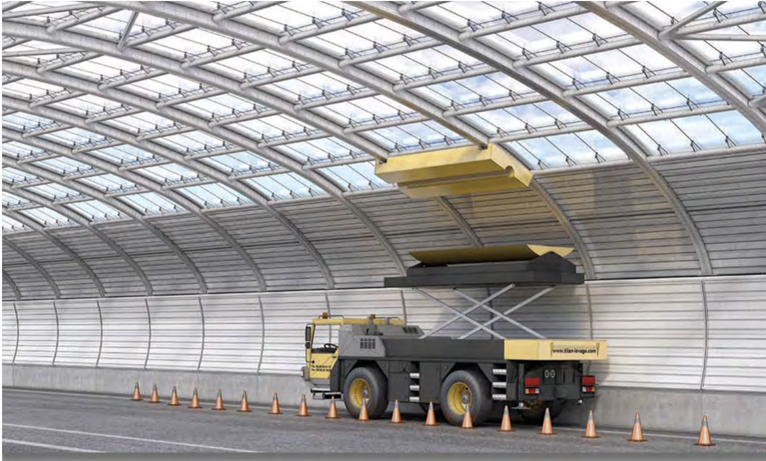
Prototipo per il monitoraggio e la pulizia in galleria ad elevato grado di sicurezza. Prototype for monitoring and cleaning in the tunnel with a high safety system.
