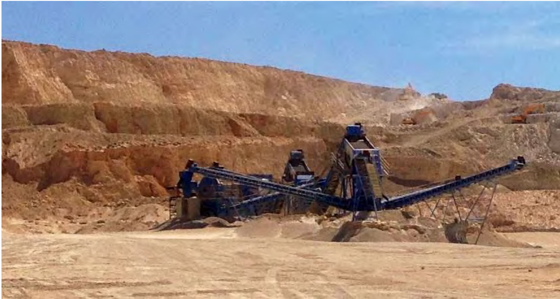
Cava e impianto di frantumazione e selezione di inerte calcareo a Tripoli, Libia.
