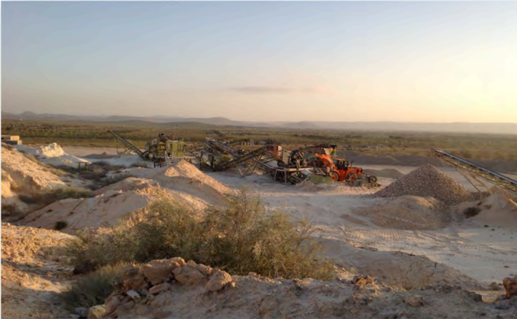
Cava e impianto di frantumazione e selezione di inerte calcareo a Tripoli, Libia. Cave plant, for crushing, and grading of limestone in Tripoli, Libya.
