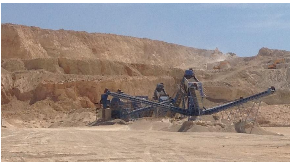
Figura 6: Impianto di frantumazione di calcare in Libia
