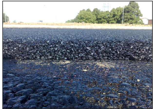
Figura 19: Conglomerato per strato di usura drenante - fonoassorbente
