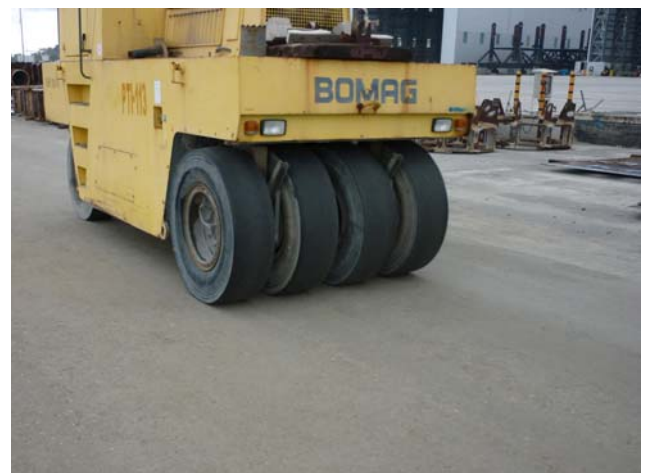
Figura 16: compattazione con rullo gomma/gomma
